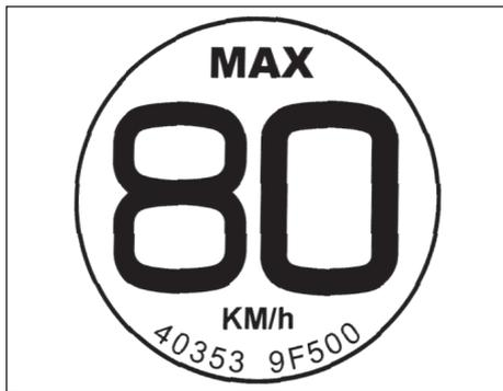
Маркировка малоразмерного запасного колеса, предназначенного только для временного использования
