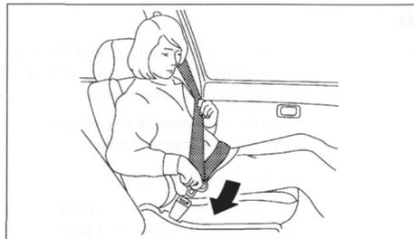
2. Медленно вытяните ремень из инерционной катушки и вставьте запорную скобу в замок до щелчка.
